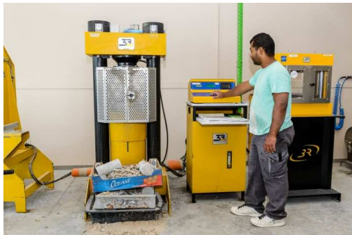
Test de résistance à la compression après rectification
