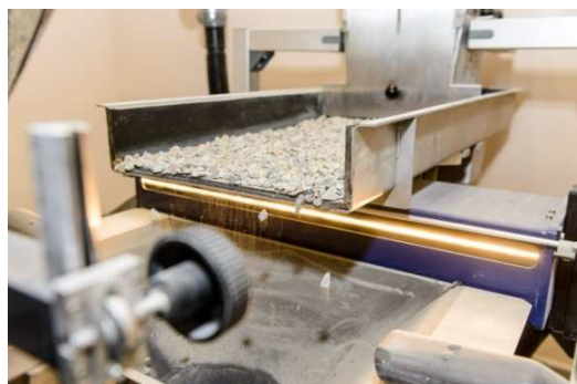
Analyse granulométrique réalisée ici par mesure optique traitée par ordinateur à l'aide d'un vidéogranulomètre.
