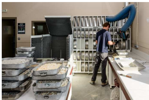
Poste de travail équipé d'un bras d'aspiration des poussières dégagées lors des essais.
